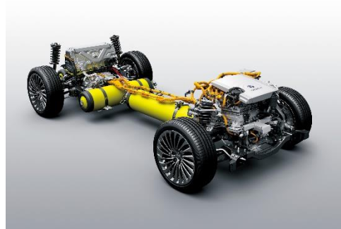
新型「MIRAI」の燃料電池ユニット
