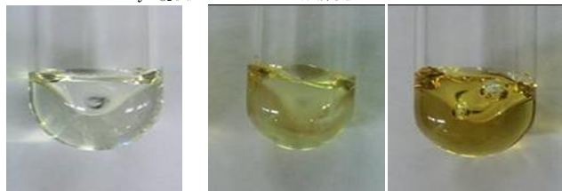
写真左から「TOYOBO GS Catalyst®」、アンチモン触媒、チタン触媒をそれぞれ使用して製造した PET 樹脂を加熱・溶融(300℃、2 時間)した際の黄変等の様子
