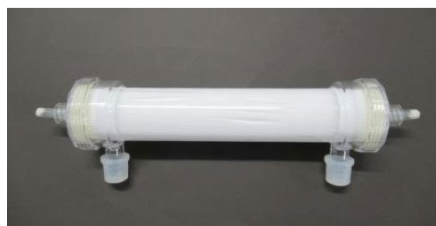
新開発のカチオン成分分離膜デバイス外観
