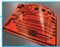
“COCOMI”を使用した配線パターンのサンプル
