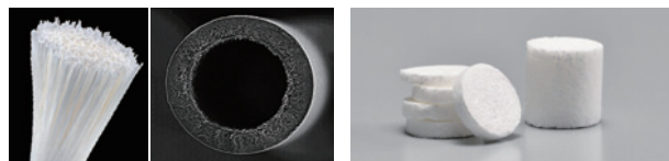
プロセス分離膜とその断面写真
