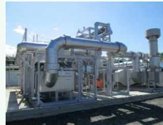
溶剤を回収する VOC回収装置 吸着回収式でトップシェア
