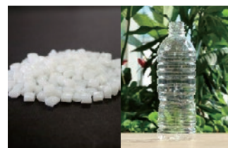
当社が重合した100%バイオPET樹脂(左) サントリーグループとAnellotech社が開発した植物由来原料100%使用ペットボトル(提供:サントリー)(右)
